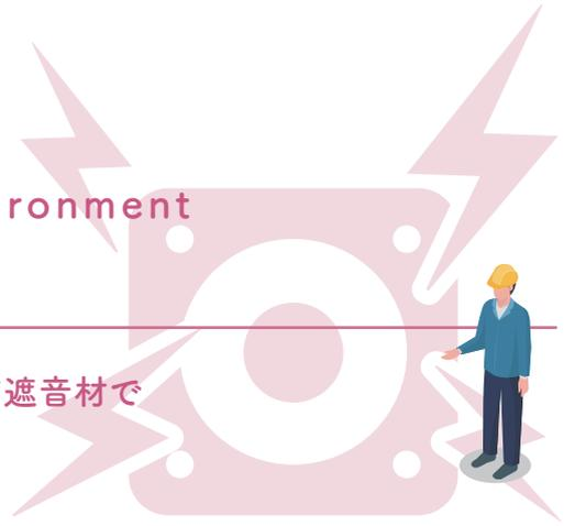
屋内作業場においては作業場内の騒音源となる機械設備について遮音材で覆うことや低音の装置に切り替えるなど騒音の抑制措置をとる。
