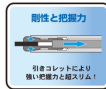
振れ精度は、0.01mm以内(口元から4D)を実現!
