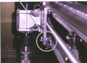
穴開け加工機の チャック部(手動)の位置決め
