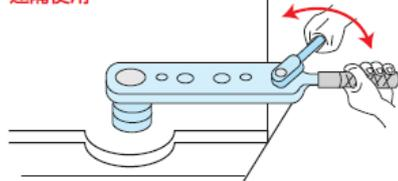
バリヤレンチの一般的な使用は、この遠隔使用です。バリヤレンチのストレートバーを握り、ラチェットレンチが障害物を避けて使用できます。
