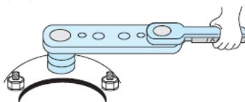
ボルト・ナットの脱着時、錆び等で固いときがあります。こんなときは、バリヤレンチのストレートバーとラチェットハンドルを一緒に握って回してください。倍のトルクがかり楽にゆるみます。
