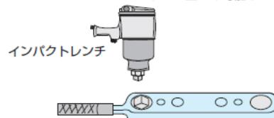
インパクトレンチをバリヤレンチと併用することにより、インパクトの使用範囲が飛躍的に増大します。ただし、インパクトレンチの入力は180N・m以下で使用してください。
