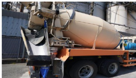
ミキサー車等のシュート機構内外飛散防止
