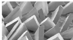
3M™ キュービトロン™ II 研磨材製品は、3Mの開発した「精密成型セラミック砥粒」を、切削性能が最大限に引き出される角度に垂直配列。それぞれの砥粒が常にナイフのような鋭い切っ先を保ち、発熱を抑えつつ高い研磨性能を発揮します。
